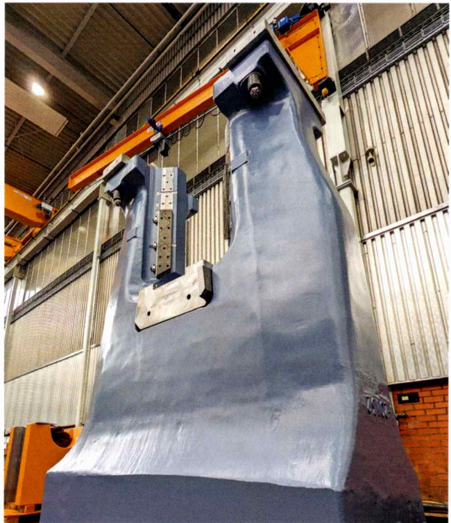
Allein das massive ca. 58 t schwere U-Gestell des neuen Umformaggregates ist schon eine imposante Erscheinung. © Lasco
